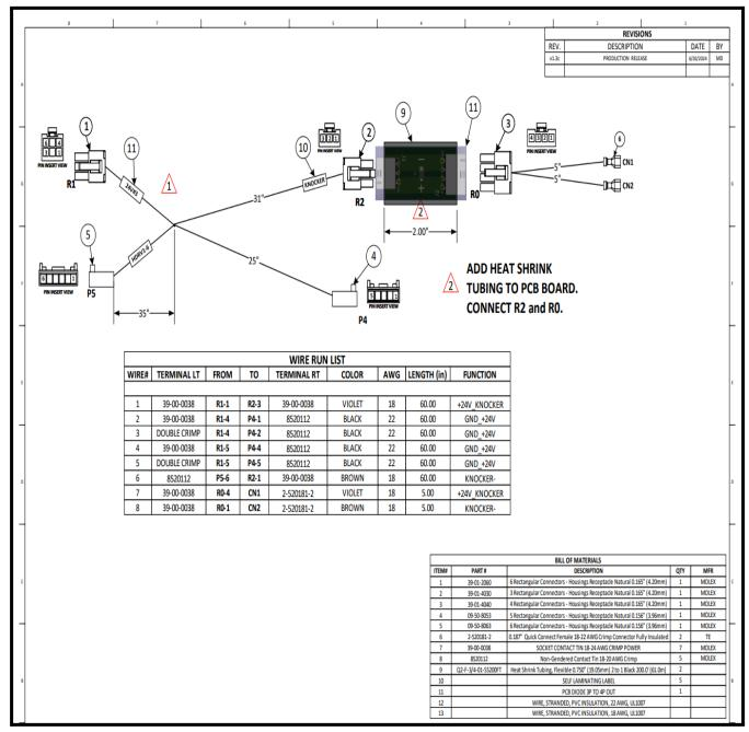
FIGURE 20. PINBALL KNOCKER (HDRV) HARNESS DIAGRAM
