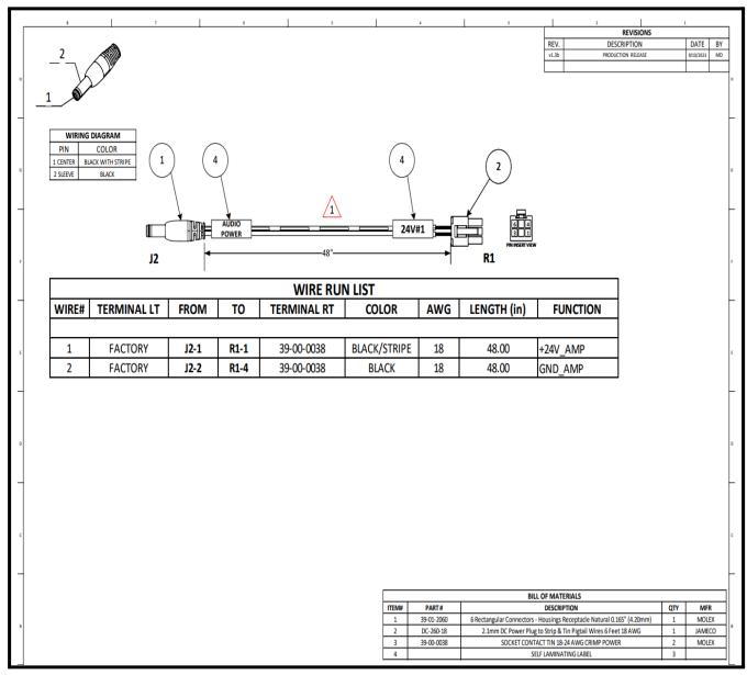
FIGURE 19. AUDIO POWER HARNESS DIAGRAM
