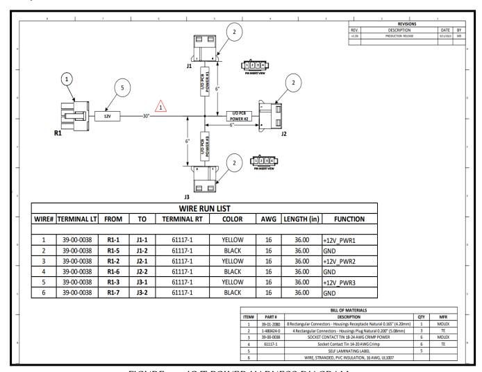
FIGURE 17. IO/T POWER HARNESS DIAGRAM
