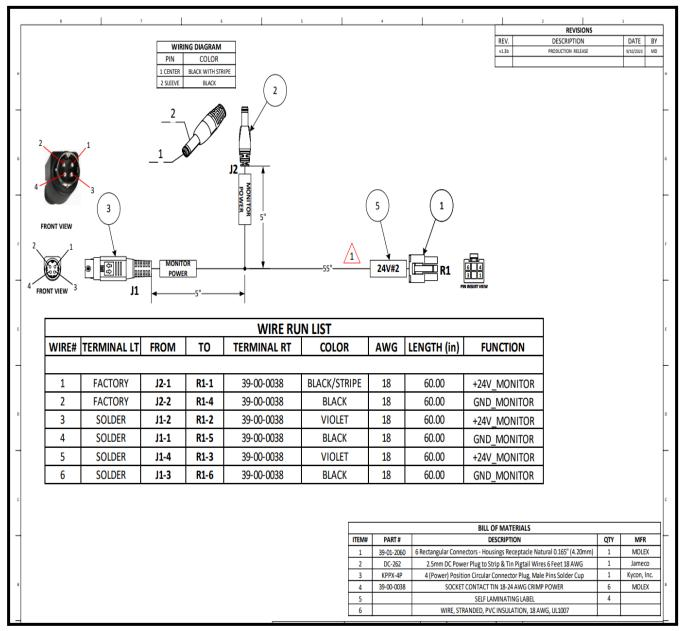
FIGURE 18. MONITOR POWER HARNESS DIAGRAM
