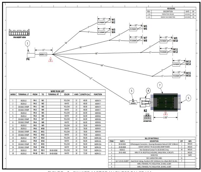
FIGURE 16. SHAKER MOTOR HARNESS DIAGRAM
